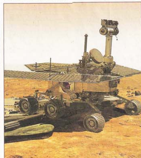
GLEICH zwei Mars-Rover der NASA sollen ab Januar 2004 den Planeten erkunden. Die je 150 Kilogramm schweren Rover sollen täglich eine Entfernung von bis zu 100 Metern auf der Oberfläche des Roten Planeten zurücklegen. Foto: JPL/NASA
